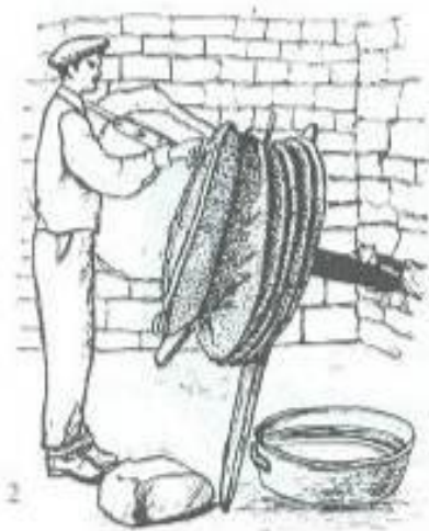
XXI tablo. Demirci alat va havazmanı: 1 – Zindan kötüyü, düzbocaq, tayqulaq va qosaqulaq zindanlar, eskic, möhtir; 2 – Qosaqitirik işlək halda; 3 – Xarı dası.
