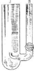
Şəkil 29. Hava qabarcıqlarının qalxma sürətinə görə özlülüyü təyin edən cihaz.
