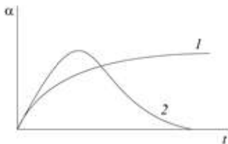
Şəkil .25 Şişmənin kinetik ayrılırları: 1-məhdud şişmə;
