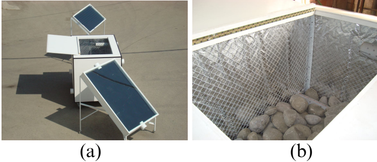
Şəkil 10.1. Günəş istilik akkumulyatoru hava və su qızdırıcı ilə birgə (a), günəş istilik akkumulyatorunun daxildən görünüşü (b).
