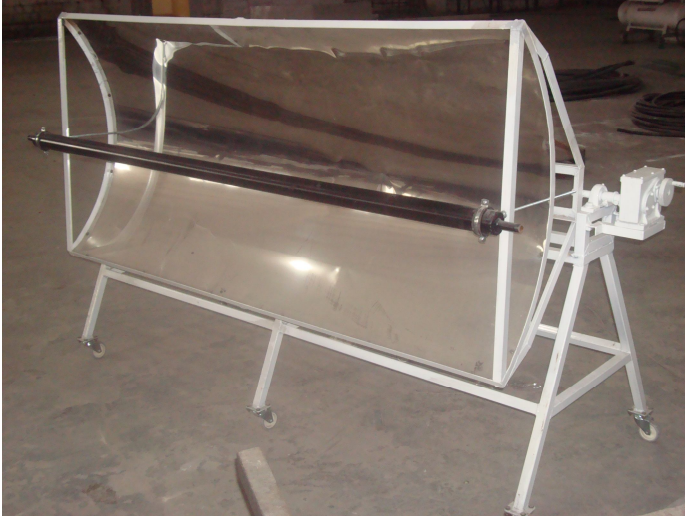
Şəkil 14.4. Paslanmayan polad vərəqədən hazırlanmış parabolosilindirik konsentrator.
