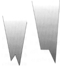
Şəkil 4-19. Zondun ucunun iki yerə ayrılması ilə nümunə səthində xüsusiyyətlərin təsvirləri iki dəfə alınır, yeni şəkillərin alınmasında zondun hər iki ucu növbələşərək iştirak edir.
