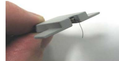
Şəkil 4-30. Pyezoboruya qoyulmuş iynə.
