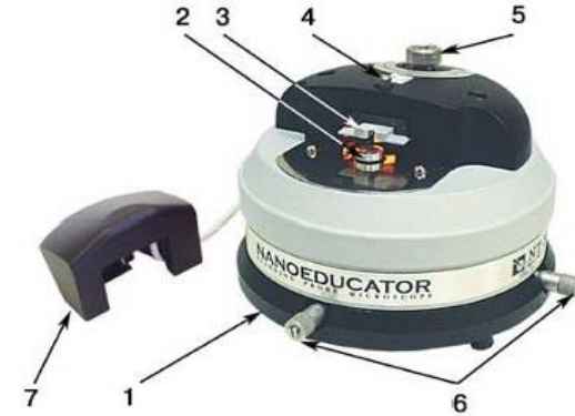
Şəkil 1-10. SZM NanoEducatorun ölçən başlığının xarici görünüşü: 1 - əsası; 2 - altlıq; 3 - qarşılıqlı təsir çeviricisi; 4 - çeviricini nizamlayan burğu; 5 - əl ilə gətirmə burğusu; 6-nümunələrlə birlikdə skanedicinin yerləşmə burğusu; 7 - kamera ilə birlikdə qapaq.
