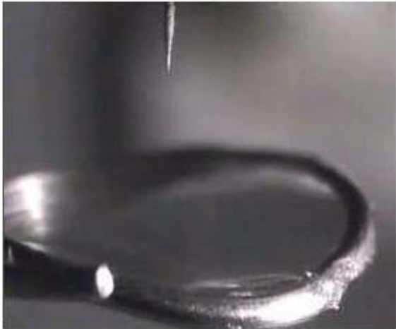
Şəkil 4-24. Optik mikroskopda alınmış İHQ həlqə və zondun ucu.
