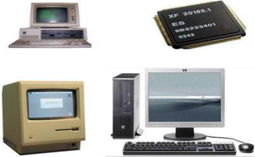
Şəkil 4.5. IV nəsil kompüterlər, element bazası – BİS
