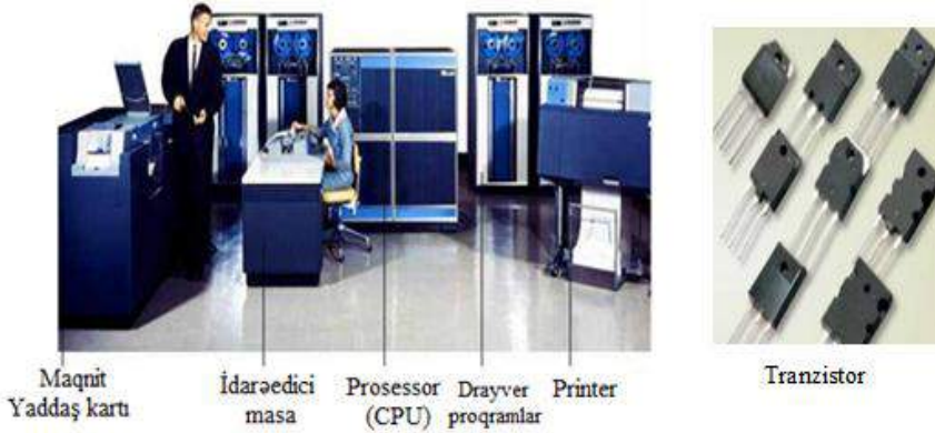
Şəkil 4.3. II nəsil kompüterlər, element bazası – tranzistor
