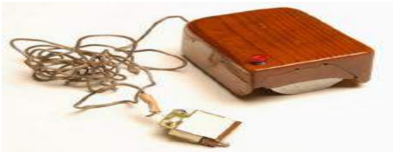
Şəkil 6.18. Xerox firması tərəfindən yaradılan maus
