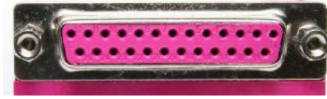
Şəkil 6.4. 25 kontaklı birləşdiricili paralel port
